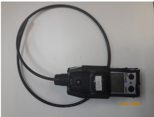
ภาพที่ 2-56 อุปกรณ์ตรวจสอบการรั่วไหลของก๊าซ (Gas Detector)
